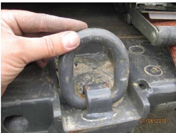
Bild 3.4: Beispiel einer Zurröse
