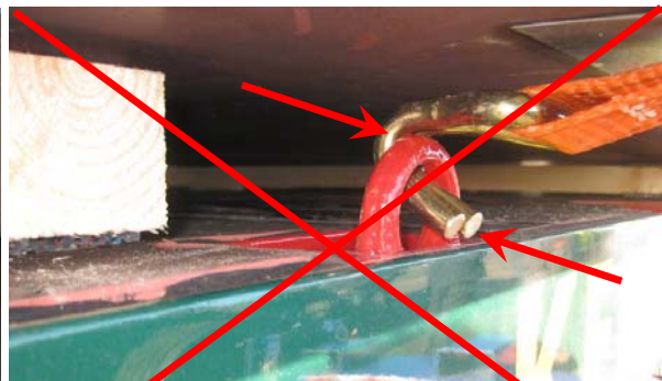
Hakenspitze liegt auf, Haken nicht im Hakengrund belastet. Der Haken wird auf Biegung beansprucht und kann brechen!
