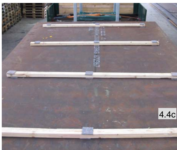
Bild 4.4: Zwischengelegte Abschnitte Rutschhemmendes Material
