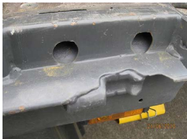
Bild 3.5: Beispiel eines Lochaußenrahmens
