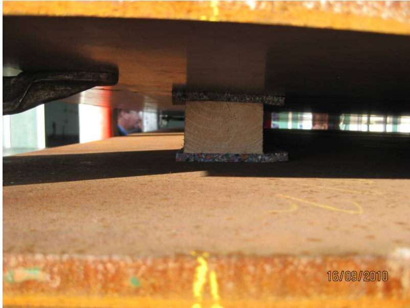
Bild 4.5: Die Breite der Kantholzunterlagen muss größer sein als die Höhe
