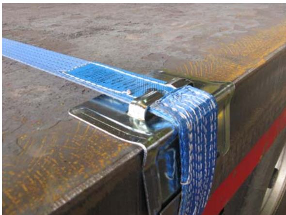
Bild 4.1: Beispiel für einen geeigneten Kantenschutzwinkel
