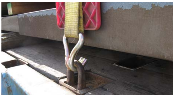
Haken im Hakengrund belastet. Hakenspitze darf nach innen oder nach außen zeigen.
