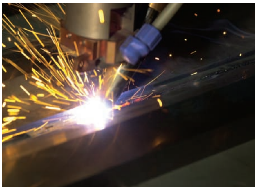
Abb. 8: Stahlfeinblech mit schweißgeeignetem Korrosionsschutzprimer - Laserstrahlschweißen
