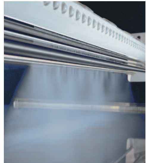
Abb. 3: Einölaggregate: Walzenbeölung (links oben) [5], Sprühbeölung (links unten) [5], elektrostatische Beölung mit Hotmelt-Inline-Vorrichtung (rechts oben) und elektrostatische Beölung mittels Sprühnebel (rechts unten)
