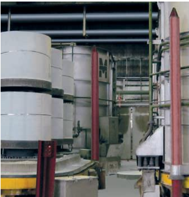
Abb. 8: Anlagen zur Herstellung von Elektroband (Kaltwalz-Reversiergerüst, oben links, Durchlauf-Glühofen, oben rechts, Hochtemperaturglühung beim komorientierten Elektroband, unten links, Domänenverfeinerung mit Laser, unten rechts)
