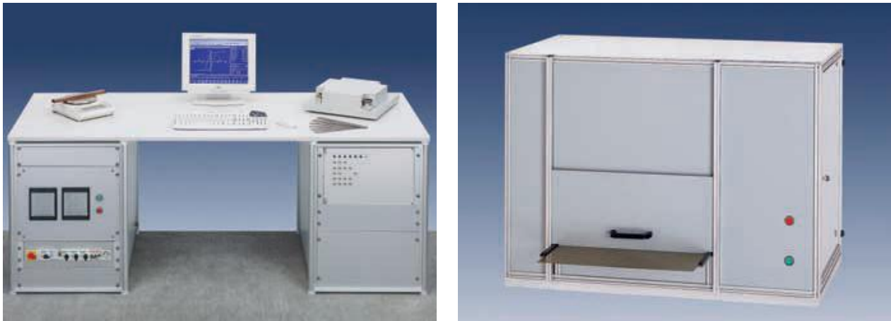
Abb. 9: Geräte zur Ermittlung von magnetischen Eigenschaften an Elektrobandproben (Messgerät mit Epsteinrahmen, links, Tafelmessgerät, rechts)
