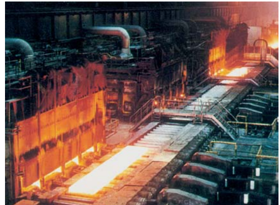
Vorstraße eines Warmbreitbandwalzwerkes
