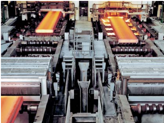
Brammenstranggießanlage mit zwei Strängen
