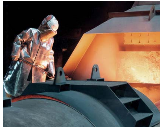
Abgedeckte Roheisenrinnen in der Hochofengießhalle während des Hochofenabstichs
