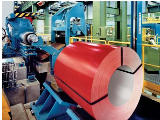
Oberflächenveredeltes bandbeschichtetes Stahlfeinblech für die Automobil-, Hausgeräte- und Bauindustrie
