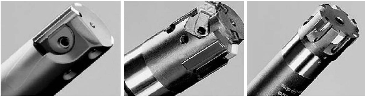
Abb. 21: Ein-, Zwei- und Mehrschneidenreibahnen mit PKD- oder PCBN-Bestückung (Quelle: Mapal)
